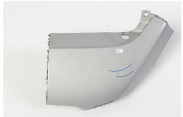
Pd2: Plastdetalj förlackerad med silver metallic Volvo 711 och klarlack. Förproducerad skrapskada.
