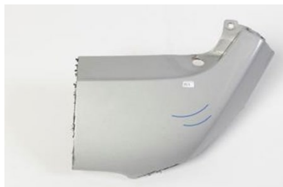
Pd2: Plastdetalj förlackerad med silver metallic Volvo 711 och klarlack. Förproducerad skrapskada.
